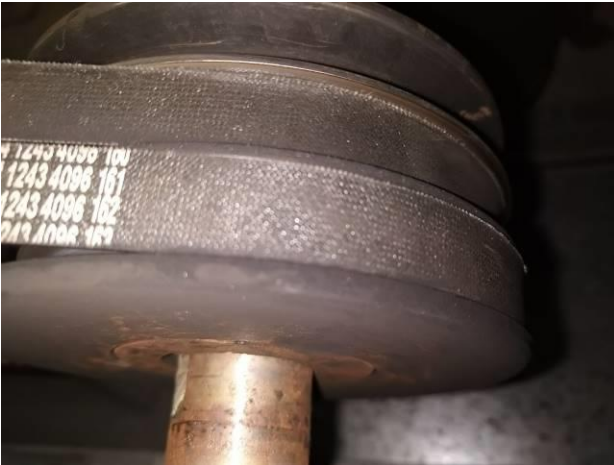
Kuva 77. Hihnat olivat osittain löysällä ja erittäin kuluneet
